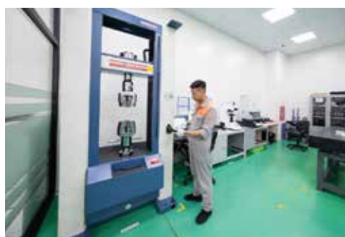
引張応力試験/Tensile Stress Testing
